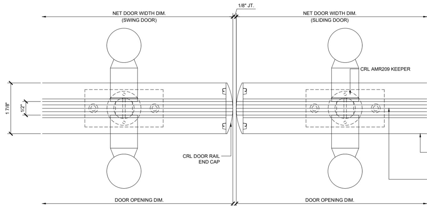
18 SWING DOOR JAMB AT SLIDING DOOR JAMB - CLOSED POSITION
