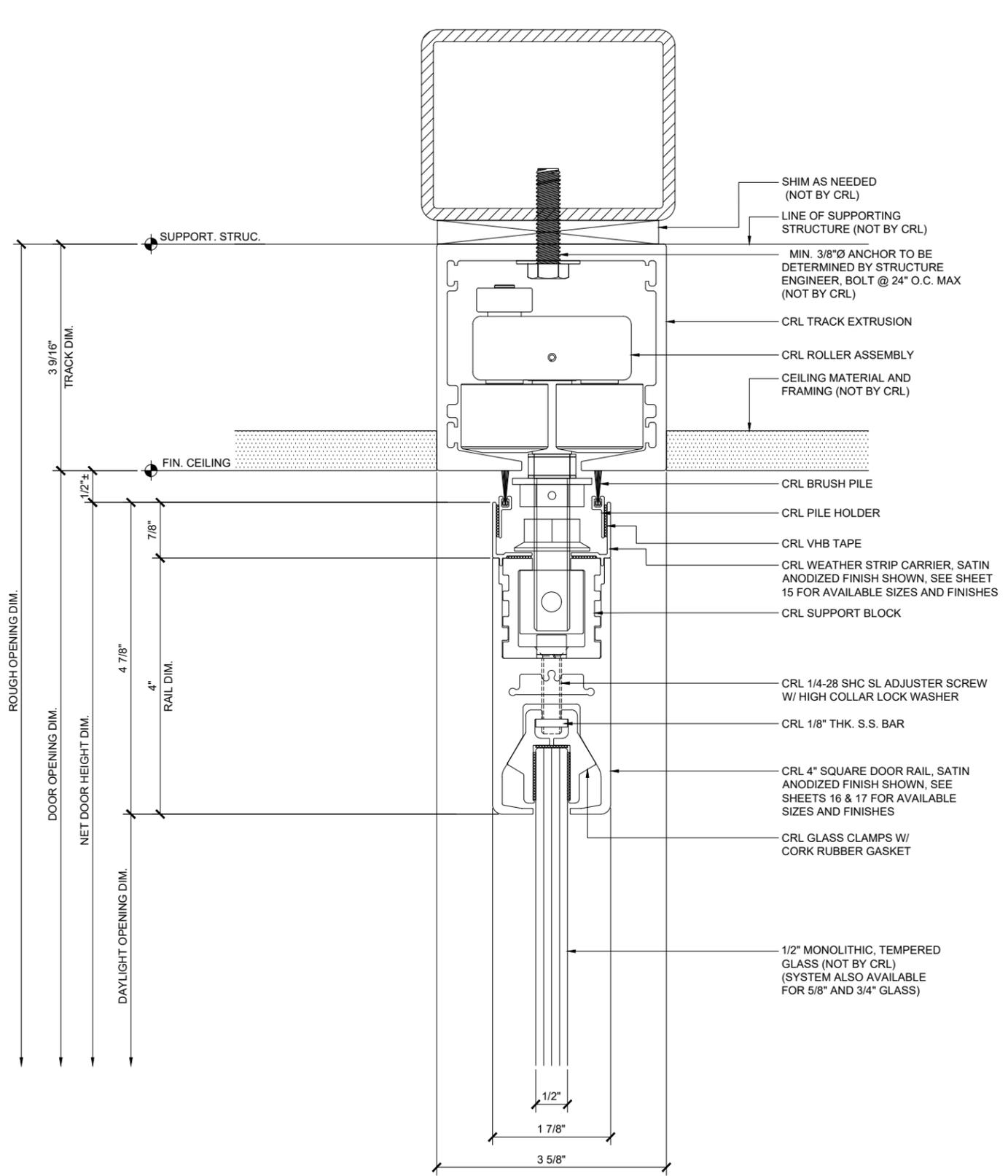
**1** DOOR HEAD - TYPICAL ATTACHMENT - AT ROLLER ASSEMBLY
