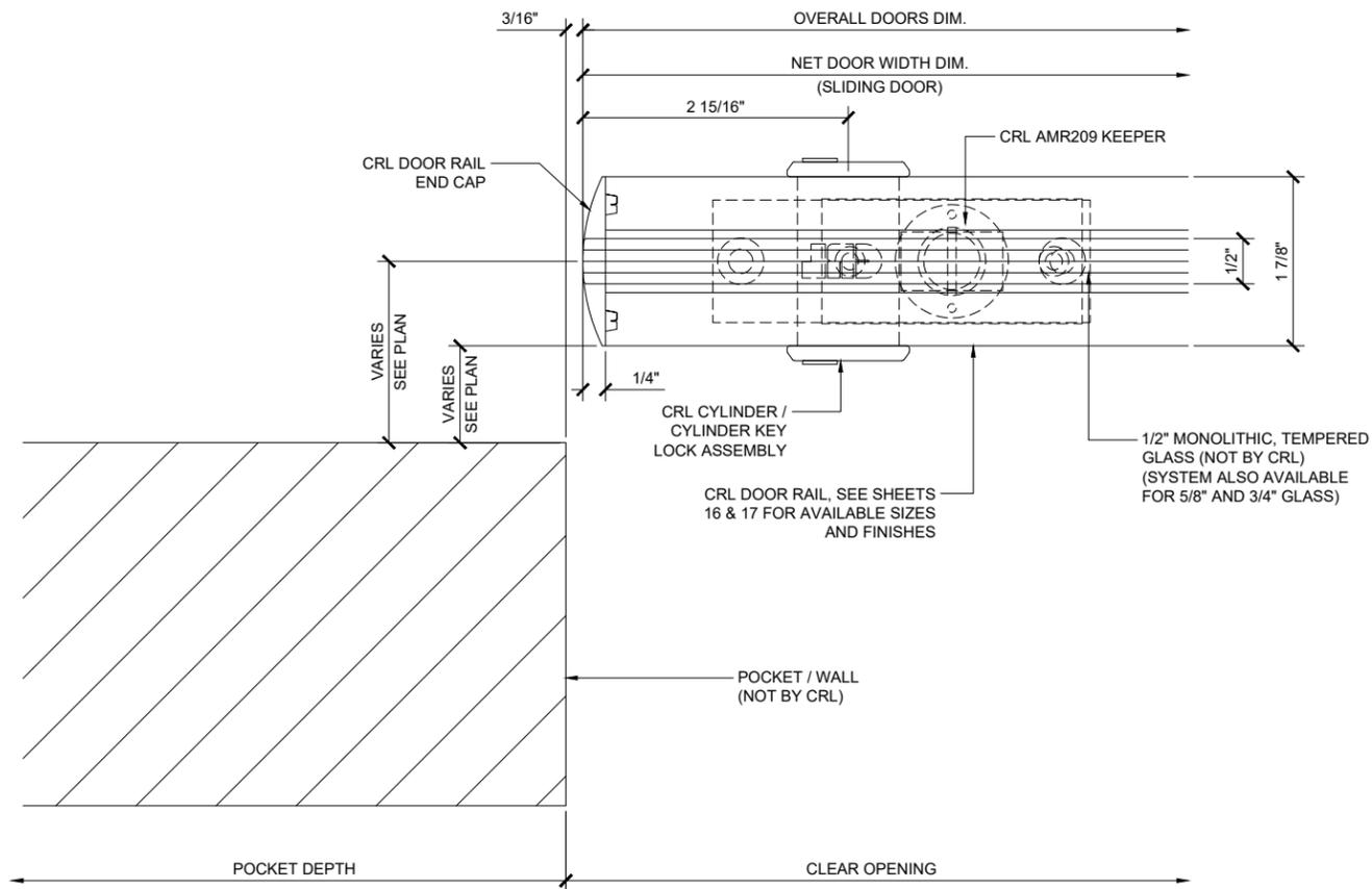
14 DOOR JAMB - CLOSED POSITION - AT POCKET / WALL
