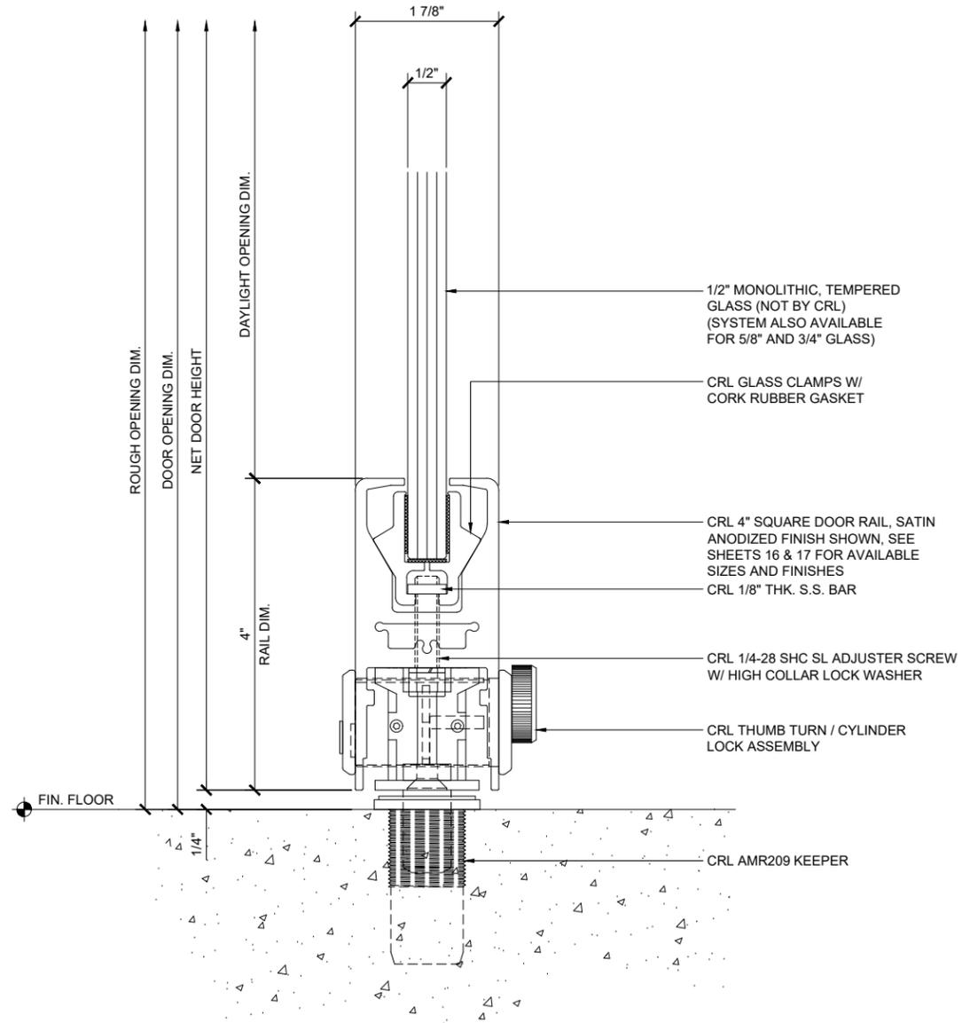
10 DOOR SILL - AT THUMB TURN LOCK ASSEMBLY
